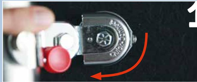
Attachez les sangles en ligne droite aux rétracteurs de sorte que, en cas de traction brusque, tirez seulement sur le cadre solide du fauteuil roulant.
