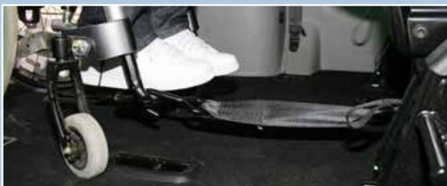
Retirez les deux sangles avant du rétracteur et fixez-les aux cadres **FIXE** et **SÛRE** du fauteuil roulant, et non aux roues!
