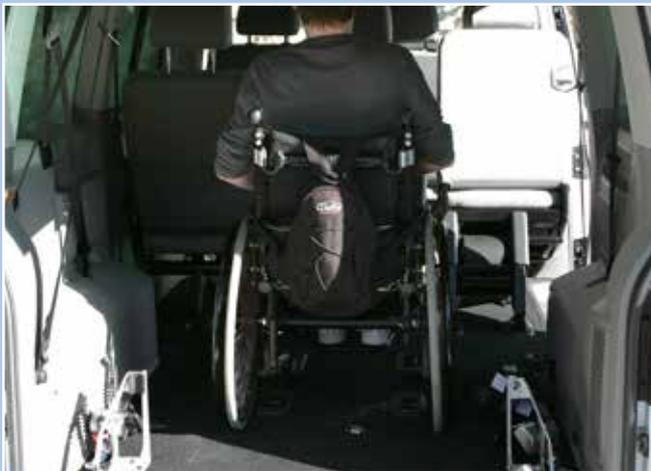
Placez le fauteuil roulant dans le véhicule à l'endroit désiré.
